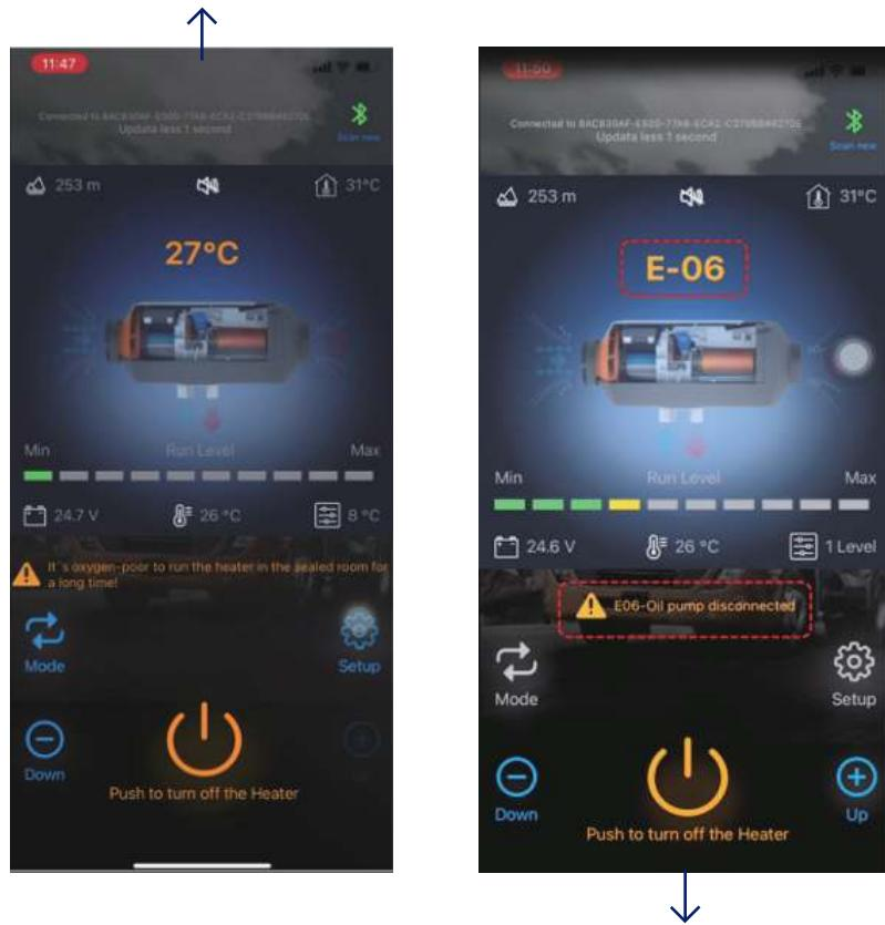
Störungsanzeige: Wenn das Heizgerät ausfällt, wird der Fehlercode E-xx angezeigt, siehe folgende Tabelle für die Art des Fehlers.
